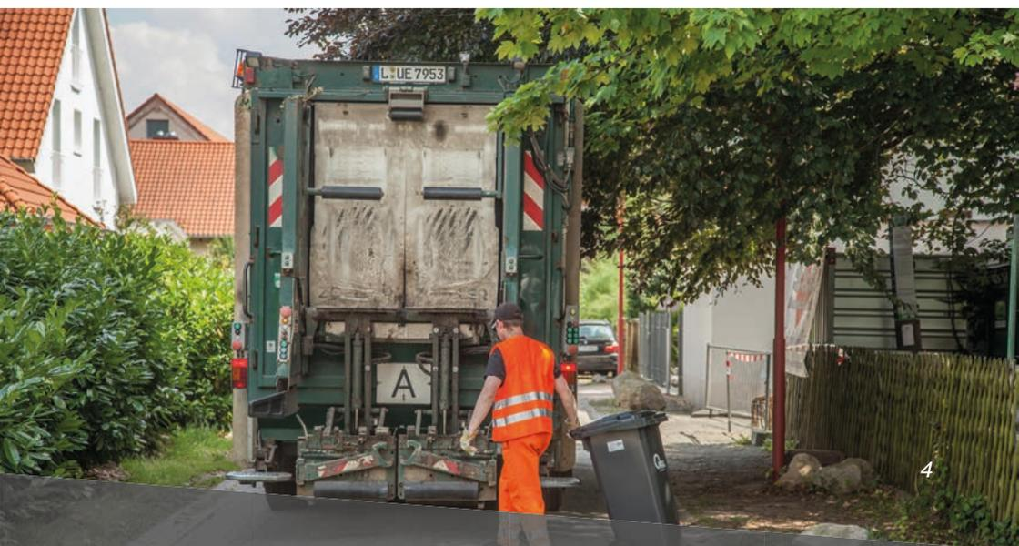
Die Bodenfreiheit von Entsorgungsfahrzeugen beträgt nur 0,3 m. Die tiefsten Punkte sind der vordere Stoßfänger und hinten die herunterklappbaren Trittbretter.
