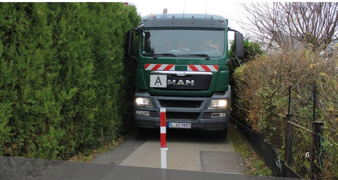
Können für Abfallsammelfahrzeuge keine Wendeanlagen geschaffen werden, so sollten Durchfahrten zum Beispiel mit Steckpfosten, Senkpfosten oder mit Schleusen ermöglicht werden.
